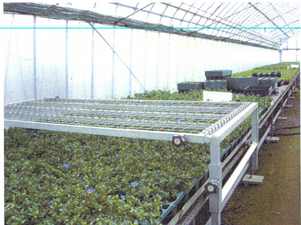
花苗の移動搬出用台車 (ベンチの両サイドのレール上を手動で移動)
